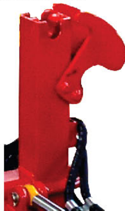
Рисунок 6.3.12.1 Положение защелки в рабочем положении, позволяющее разложить крайние секции.
