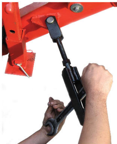
с) отрегулируйте длину растяжек с помощью фаркопфа. Длина обеих растяжек должна быть одинакова.
