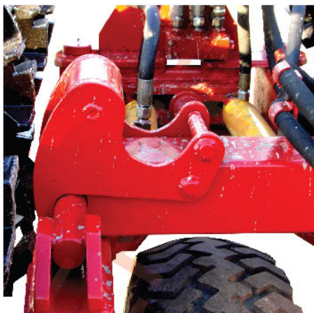
Рисунок 6.3.12.2 Автоматическая фиксация крайних секций в транспортном положении защелкой с помощью веса груза.
